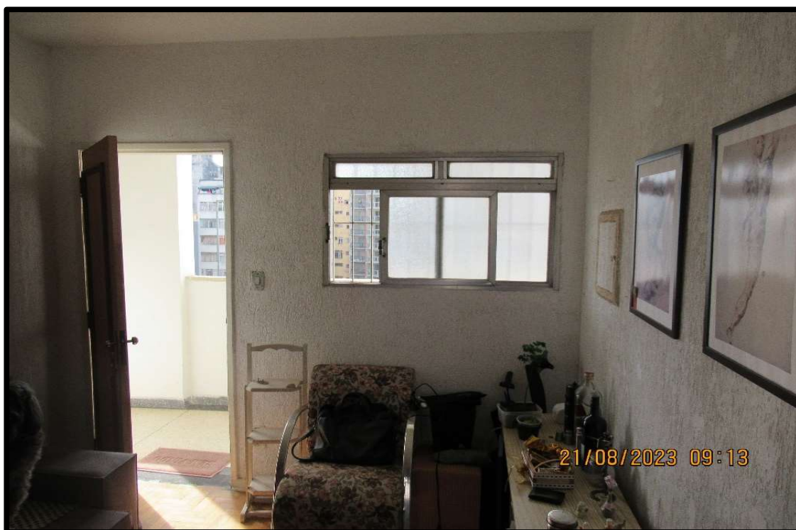
Foto nº 7: Vista da sala. Suas principais características construtivas são: piso em tacos de madeira, paredes texturizadas, forro em laje e esquadrias de alumínio.
